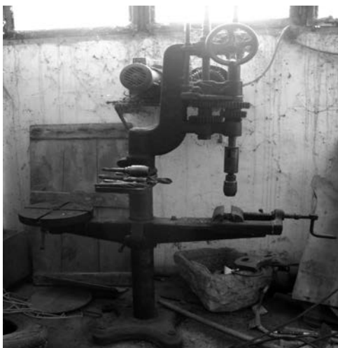
FERRER. Vicenç Sampol Cladera. Màquina de fer forats. És un exemple d'eina manual a la qual, posteriorment, s'afegí un motor elèctric.
