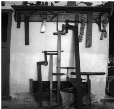
FUSTER. Gabriel Roscar Jaume. Eines de fuster, algunes utilitzades per fer carros com ara les cerques, els serjants o les aixes.
