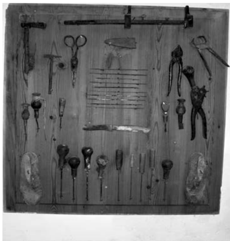
ESPADENYER. Gaspar Garcia Sastre. Eines de sabater i espardenyer. Les eines d'espardenyer són les alenes, les agulles i les tisores.
