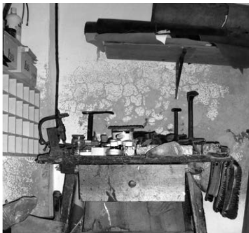
SABATER. Joan Bennàssar Mayol. Taula de treball, eines —alenes, estenalles d'entatxar, tisores, raspalls, peus de ferro i banyes—, soles i pells per fer les sabates.
