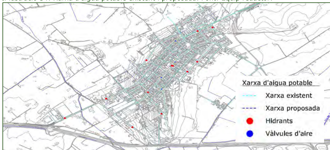
Il·lustració 34: Xarxa d'aigua potable existent i proposada. Font: Equip redactor.
